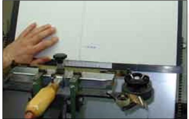
Nachdem die Decke des Buches bezogen wurde, wird in der Prägerei der Buchtitel mit dem dazugehörigen Text als Prägung ausgeführt. Durch Erhitzen des Prägestempels werden alle sich auf der Leiste befindlichen Buchstaben erhitzt, damit der zu prägende Schriftzug mit Hilfe der Prägefolie sauber und fachgerecht aufgebracht werden kann.
