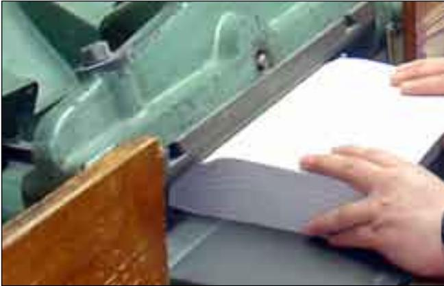
An dieser Maschine werden die gebundenen Bücher gerundet, damit sie im nächsten Arbeitsschritt in die Buchdecke eingehängt werden können und sich so problemlos an den ebenfalls zuvor leicht gerundeten Buchrücken anpassen können. Bei diesem Vorgang ist besondere Vorsicht geboten, da die Rundung erfahrungsgemäß einen sehr großen Teil zur Stabilität des Buches beiträgt.
