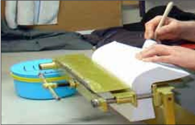
Hier werden die aus der Vorbereitung kommenden Seiten nicht wie beim Heften gebunden, sondern in einer eigens dafür konstruierten Vorrichtung eingespannt und gefächert, damit der Spezialleim auch zwischen den einzelnen Seiten eine Klebeverbindung eingehen kann. Auf diese Weise werden die einzelnen Buchseiten zu einem Block auf einer Seite befestigt.
