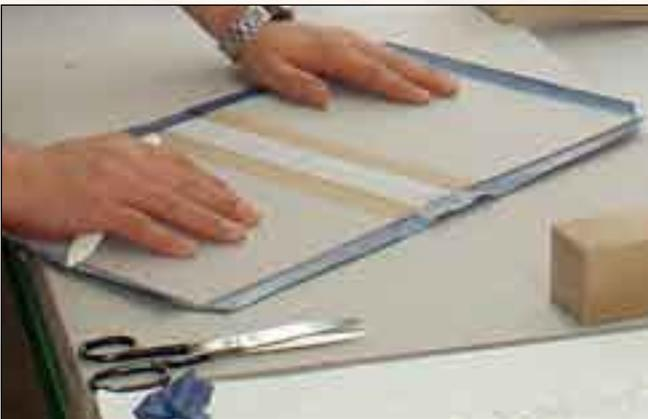
Beim Beziehen der Decke, also dem Buchcover, wird zuerst die für das jeweilige Buch erforderliche Größe ermittelt. Anschließend werden die danach zu beziehenden Pappen und das Bezugsmaterial gewählt und in sorgfältiger, routinierter Handarbeit mit einem speziellen Leim verklebt. Jedoch werden auch Standardbände wie Gesetzbücher etc. sowie industriell angefertigte Buchdecken zum Einbinden verwendet. Die Bezugstoffe sind in den verschiedensten Materialien und Farben erhältlich.
