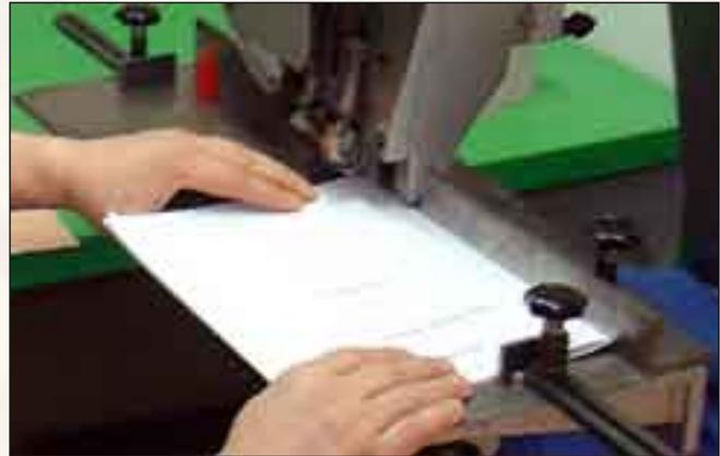
Bei diesem Arbeitsschritt werden die Blätter durch eine einfache Klammerheftung oder seitlich als Rückstich zu einem Heft oder zu einer Broschüre verarbeitet.
