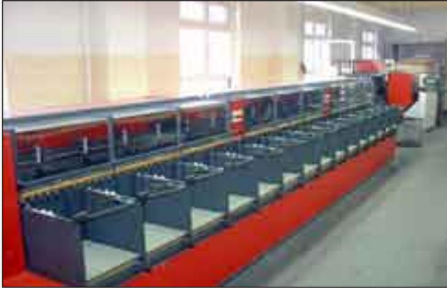
An dieser Maschine werden, eingestellt als Sammelvorrichtung, einzelne wiederkehrende Sätze oder auch Buchseiten numerisch sortiert. Verwendet als Sammelhefter ist es auch möglich, versehen mit einigen oder mehreren Mittelklammern, komplette Hefte oder Broschüren mittels einer Falzung herzustellen.
